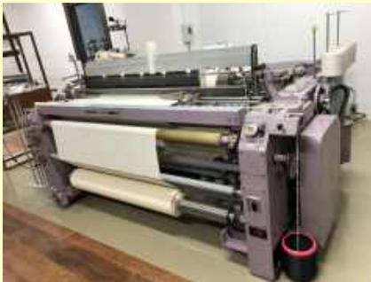
20世紀に入り、人口の急増とともに織物需要が急増したことにより、従来のシャトル織機より速く織ることができるエアジェット織機が開発された。圧縮した空気流で横糸を飛ばして織る織機であり、従来のシャトル織機の6倍の速さで織ることができる。
