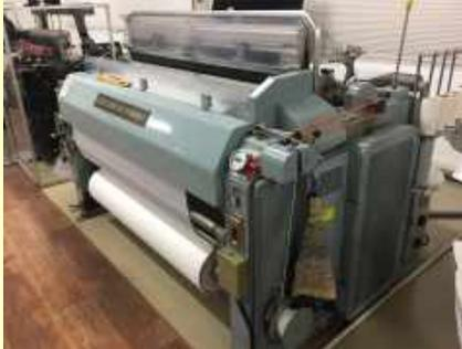
この織機は、1950年代にチェコスロバキアで生まれた“水を使ってよこ糸を運ぶ”というアイデアをヒントにプリンス自動車工業が独自開発した水の噴流でよこ糸を挿入して織る織機である。生産能力はシャトル織機の数倍有り、よこ入れは水鉄砲と同じ原理で水を噴射して行う。
