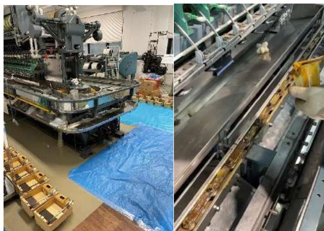
(左)自動繰糸機から給繭器をすべて外した状態 (右)チェーン部分にグリスを塗る作業を行う
